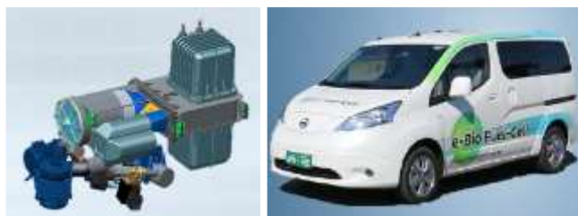
Rys. 2. Przykład rozwiązania konstrukcyjnego systemu generatora energii elektrycznej z ogniwem paliwowym typu SOFC dedykowanego do pojazdu Nissan e-NV200 [5, 20]
