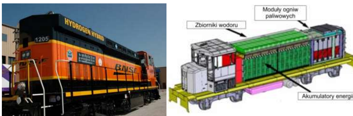
Rys. 5. Prototyp lokomotywy manewrowej i schemat układu z ogniwem paliwowym PEM [21]
