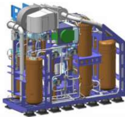
Rys. 7. System reformingu metanolu zainstalowany na okręcie podwodnym typu HWD 216 [16]
